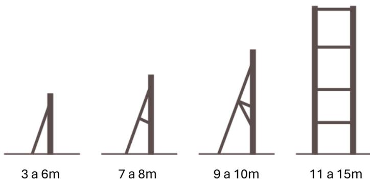
Modelo adaptado para uma instalação mais facilitada, com alturas padrão de 6000 a 15000 mm.
